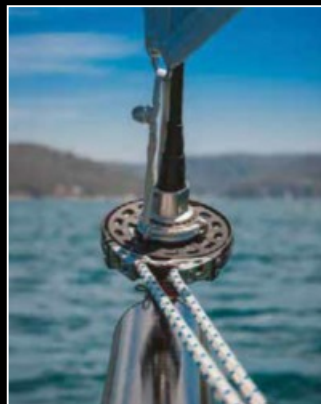
Seldén GX Top down rolsysteem voor asymetrische spinnakers of gennakers
