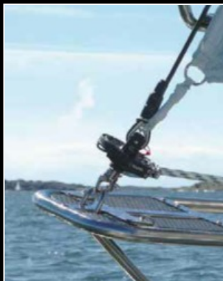
Seldén CX Rolsysteem voor code zero en stagzeil.
